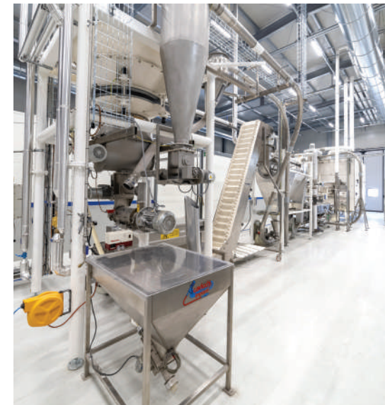
A sinistra Laboratorio R&D di Cento: linea pilota per la produzione di cous cous. A destra Laboratorio R&D sede di Collecchio: gruppo di preparazione impasto Belmix e sfogliatrice STF-540 TV (Fava Storci).
